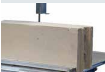
Hormigón de poros
